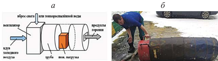
Рис. 1. Схема экспериментальной установки (а) и подготовка макета к работе (б)
