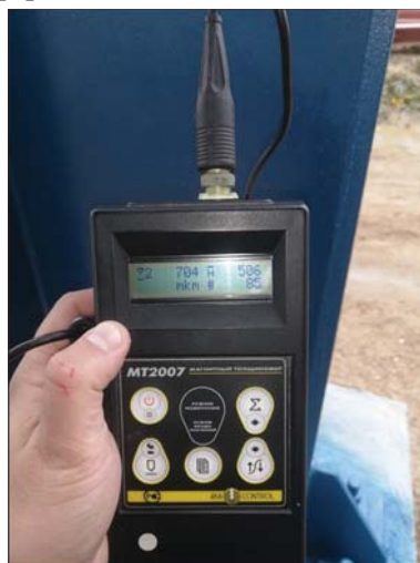
Рис. 2. Контроль толщины огнезащитных покрытий толщиномером MT2007
