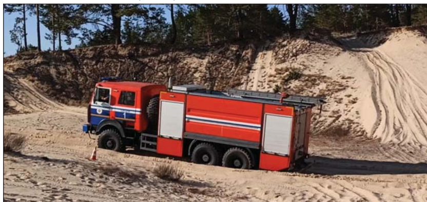
Рис. 4. Проведение заезда. Момент срыва колес в пробуксовку АЦ 10,0-40 (6317)
