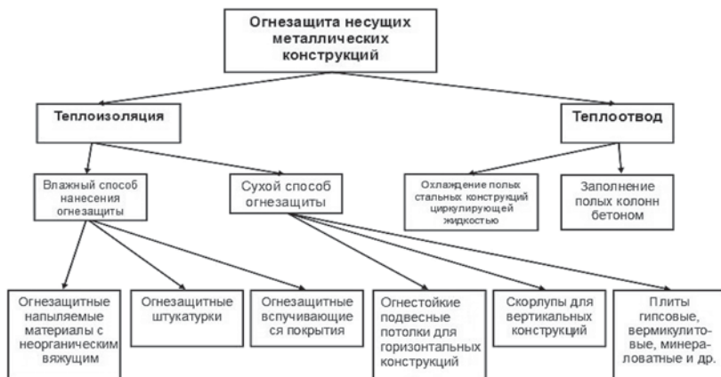
Структурно-методологическая схема выбора огнезащиты
