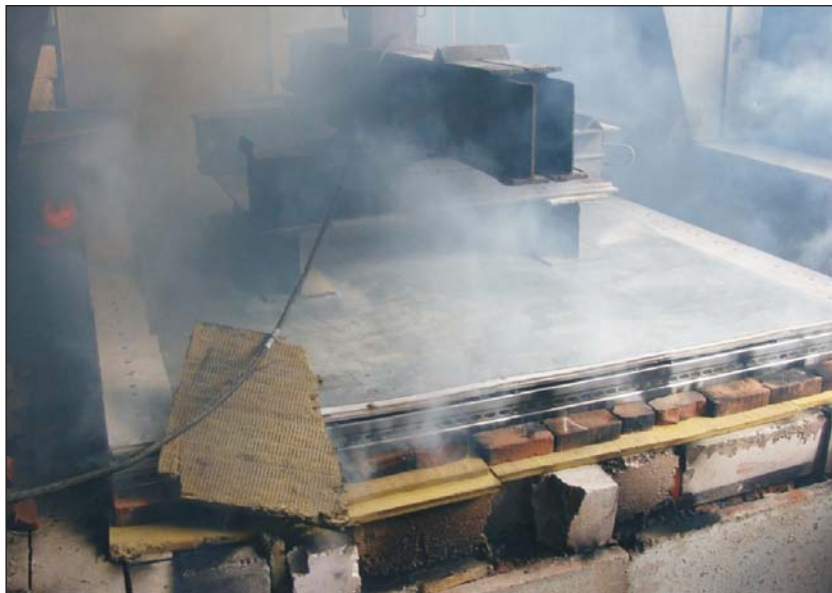
Рис. 1. Опытный образец конструкции перекрытия в процессе огневого испытания
