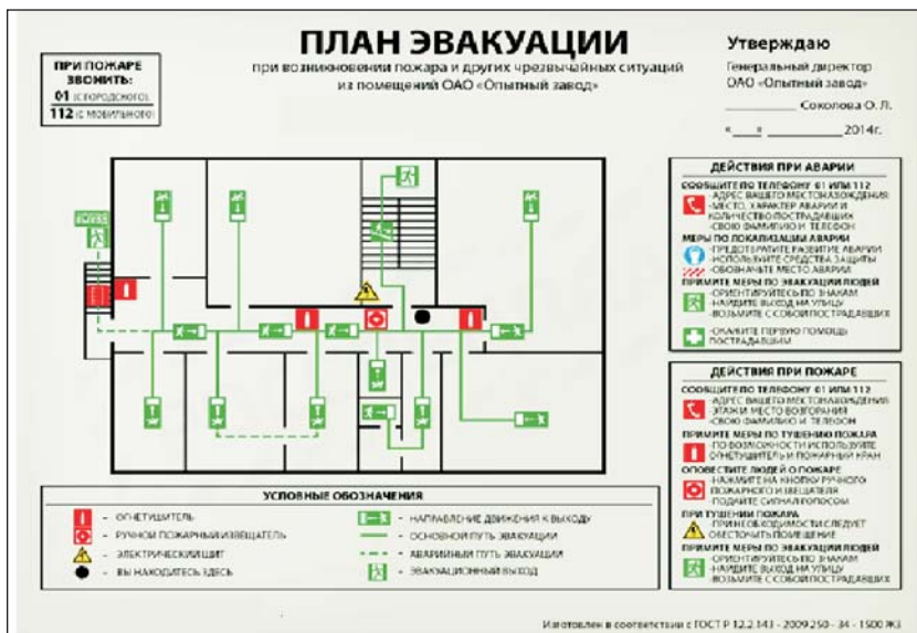
Рис. 2. Пример выполнения плана эвакуации на объектах
