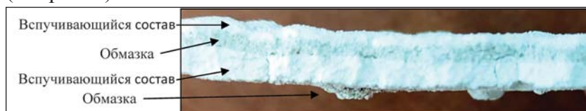
Рис. 1. Вид слоев огнезащитной конструктивной системы «UNITFIRE N»
