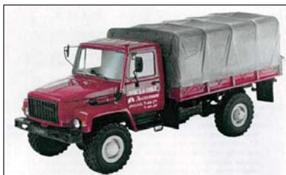
Рис. 6. Лесопатрульный комплекс ЛПК 1,4-10 ВЛ на шасси ГАЗ-33081 «Садко» производства ОАО «Великолукский завод Лесхозмаш»
