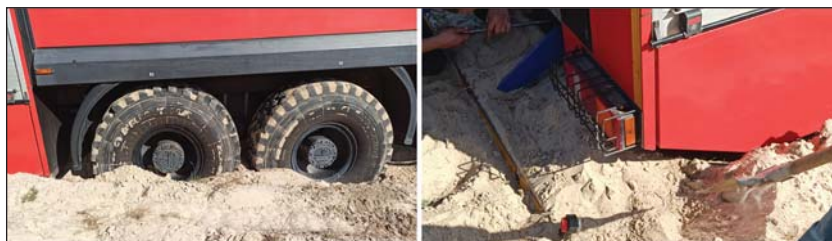
Рис. 3. Проседание колес и заднего свеса АЦ 10,0-40 (6317) в песке
