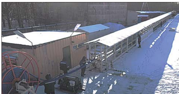
Рис. 8. Стол для испытаний рукавов на герметичность на открытом воздухе
