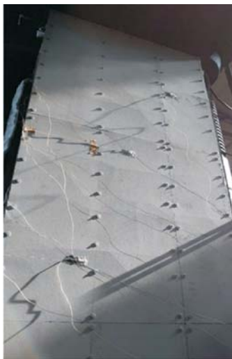
Рис. 1. Опытный образец несущей стеновой панели перед испытанием
