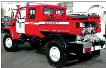
Рис. 3. Пожарный автомобиль для тушения лесных пожаров АЦ 1,6-40 (3308) производства ОАО «Пожтехника» (г. Торжок)
