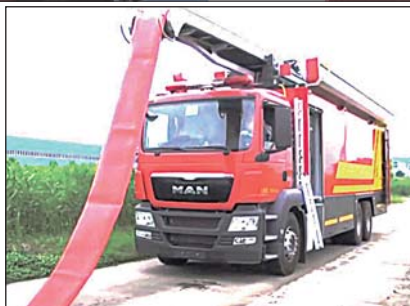
Рис. 3. Мойка рукавов при укладке рукава в отсек автомобиля
