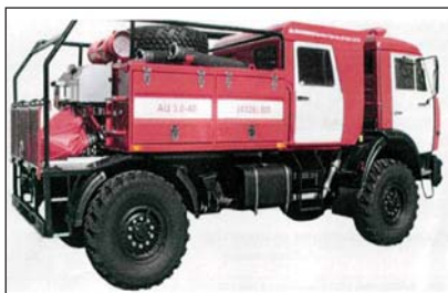
Рис. 4. Автоцистерна пожарная АЦ 3,0-40 (4326) ВЛ для тушения лесных пожаров производства ОАО «Великолукский завод Лесхозмаш»
